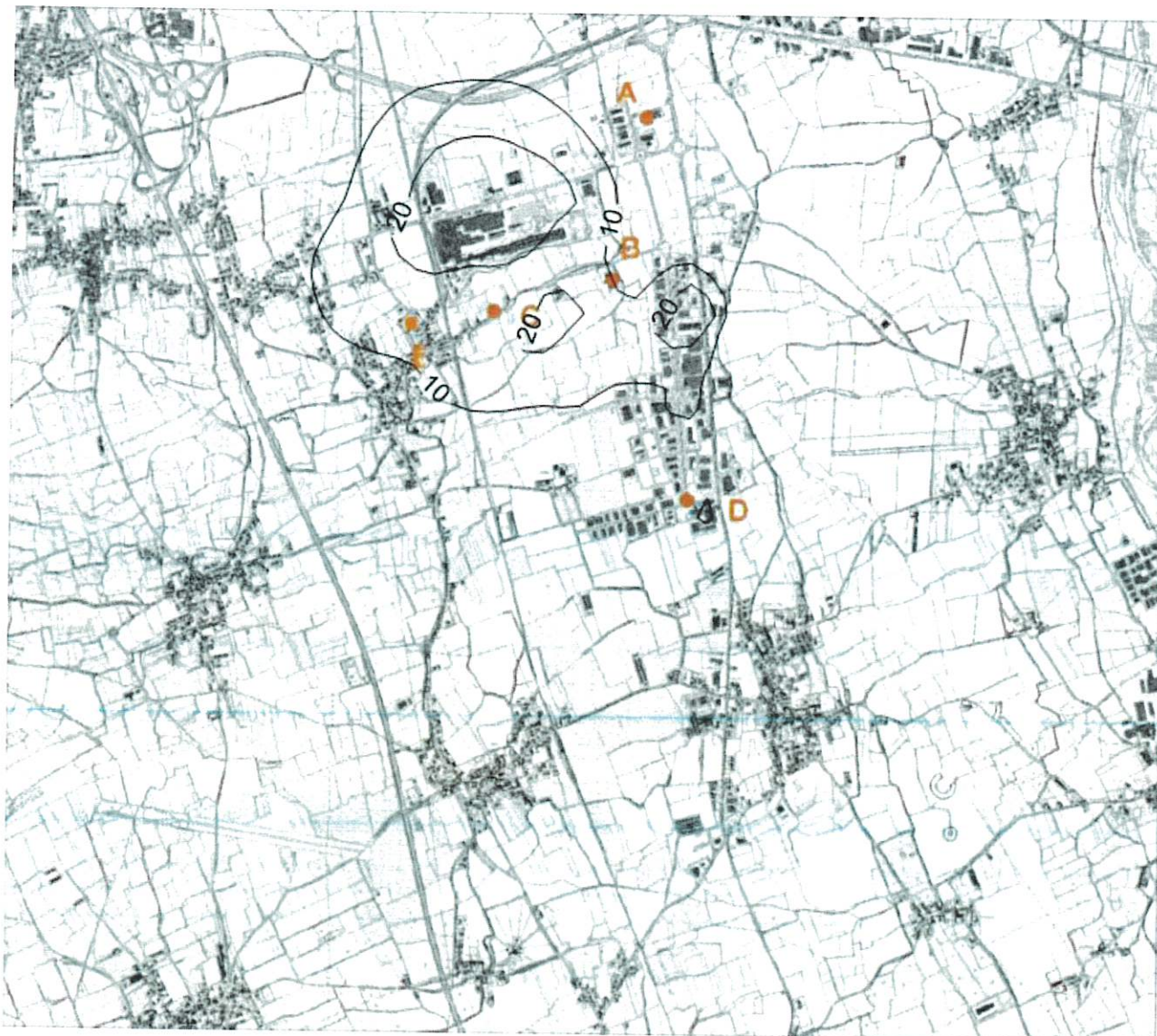
Figura 10: Mappa di ricaduta di NO 2 espressa come media annuale, escluso il contributo del traffico veicolare.
