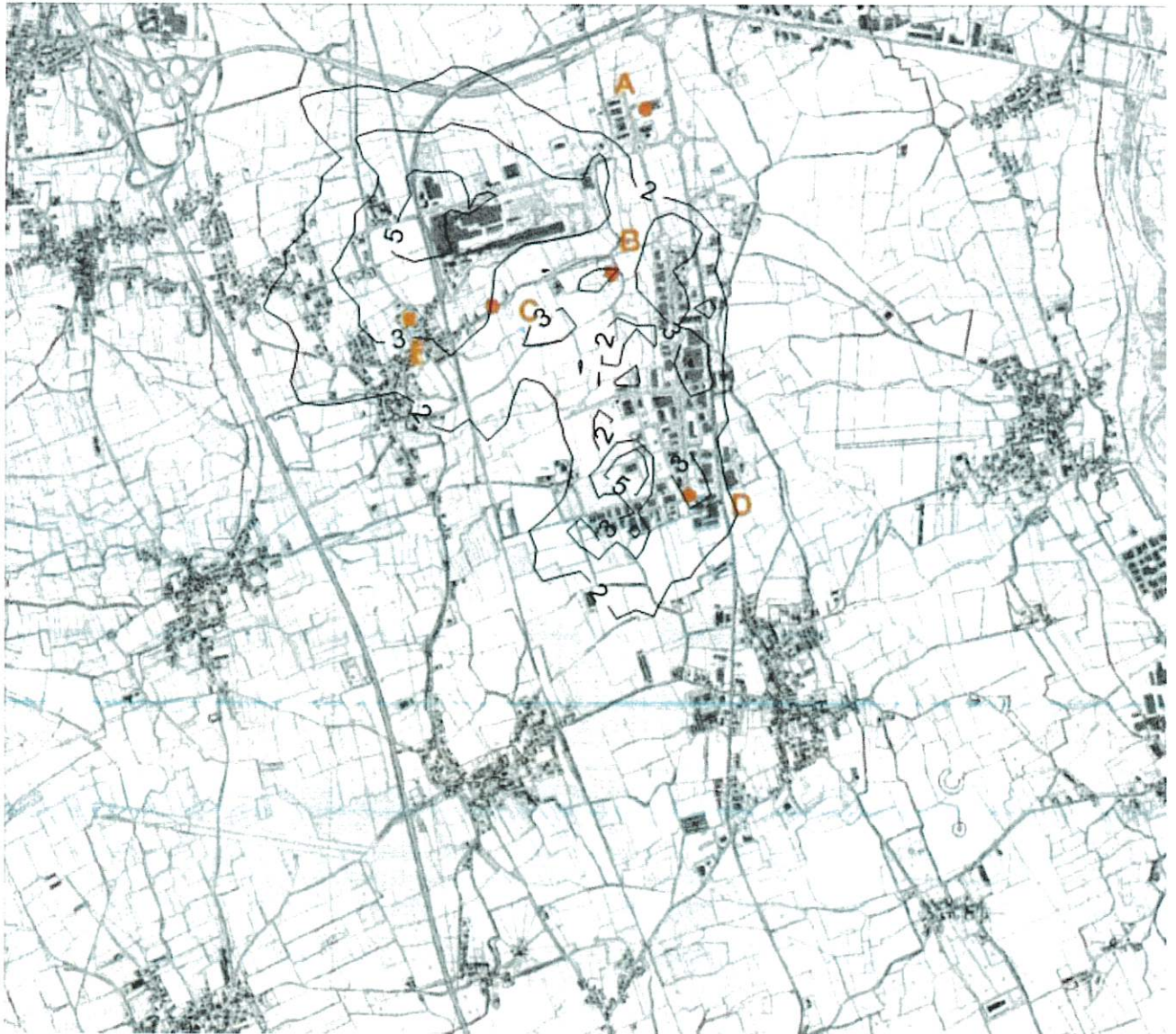
Figura 6: Mappa di ricaduta delle polveri (PM10) espressa come massimo annuale delle medie giornaliere, escluso il contributo del traffico veicolare.
