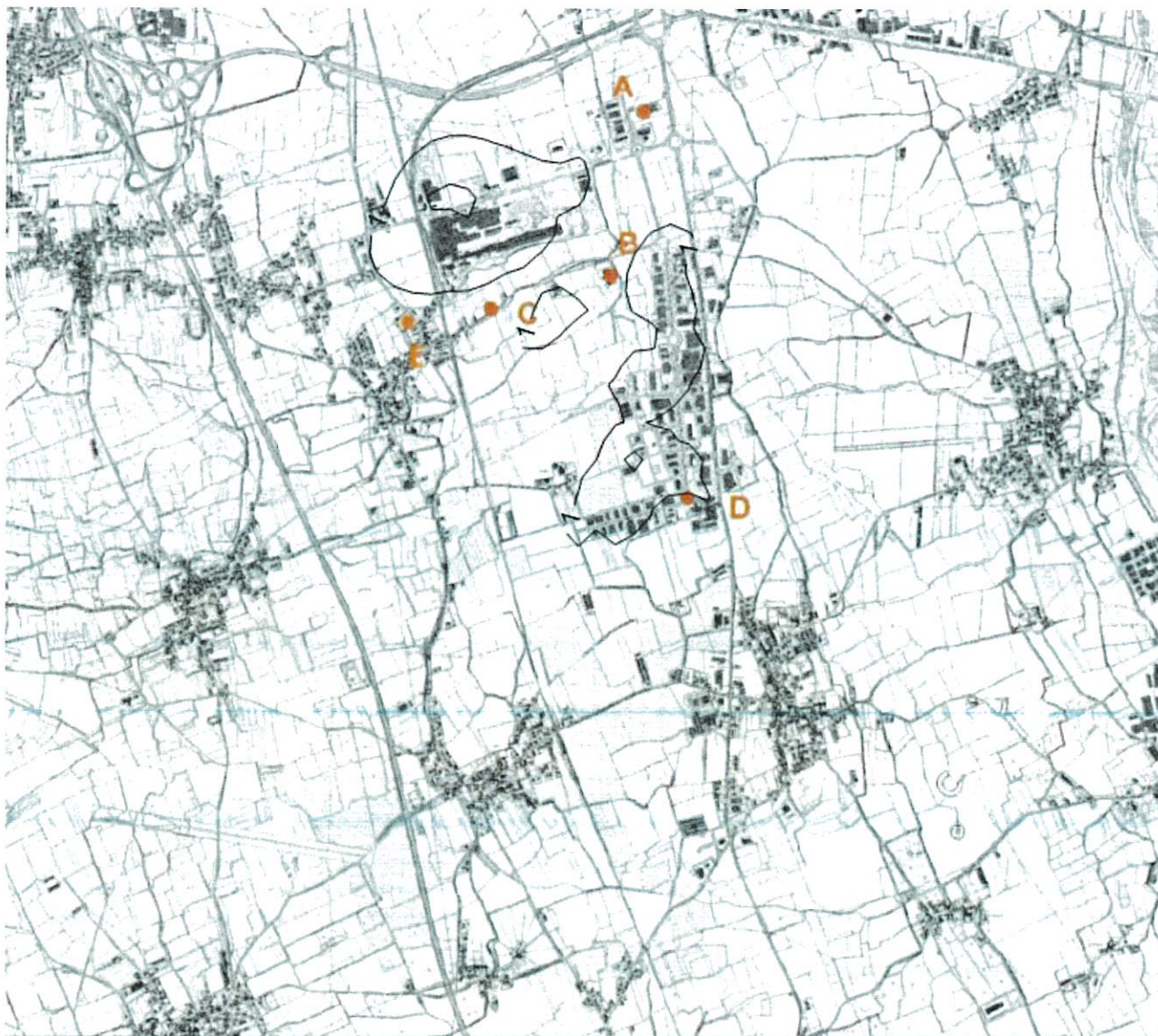
Figura 8: Mappa di ricaduta delle polveri (PM10) espressa come media annuale, escluso il contributo del traffico veicolare.
